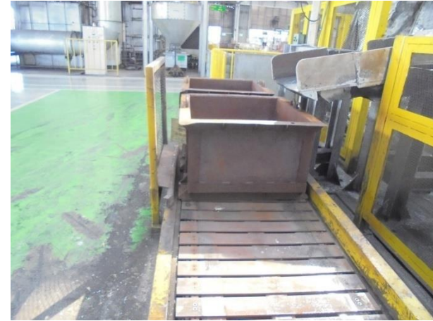
รูปที่ 2-35 ฐานรองเพื่อลดความสูงของรางลำเลียงชิ้นงานที่ออกจากขั้นตอนการผลิตลงสู่กระบะเหล็กรองรับชิ้นงาน
