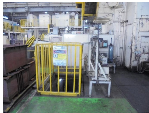
รูปที่ 2-18 บ่อคอนกรีตเก็บน้ำปนเปื้อนน้ำมันใต้เครื่องทุบขึ้นรูป
