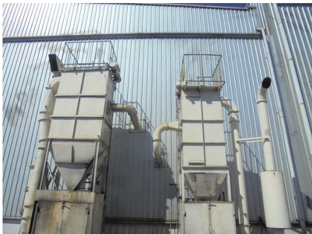
รูปที่ 2-37 ระบบบำบัดมลพิษทางอากาศแบบถุงกรอง ของเครื่องตัดผิวชิ้นงาน
