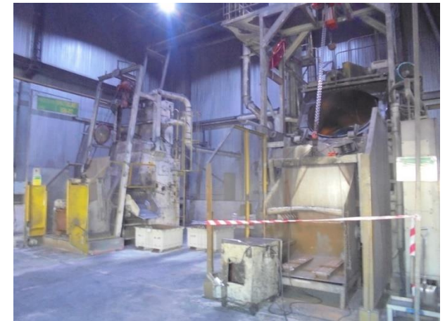
รูปที่ 2-35 ฐานรองเพื่อลดความสูงของรางลำเลียงชิ้นงานที่ออกจากขั้นตอนการผลิตลงสู่กระบะเหล็กรองรับชิ้นงาน
